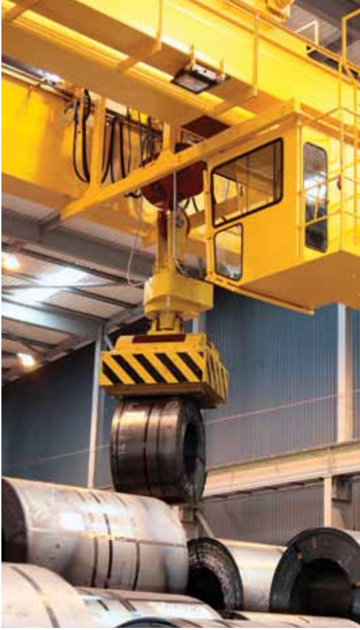
الشكل ٨ يُستخدم المغناطيس لرفع بعض الأشياء المعدنية الثقيلة.
